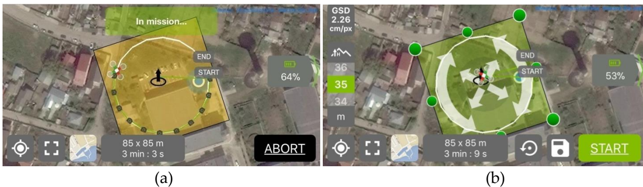
Figura 1 – Preluarea imaginilor UAV asupra câmpului de calibrare și testare a camerelor digitale nemetrice montate pe platforme aeropurtate fără pilot, la înălțimea de 28 m (a) și 35 m (b)
