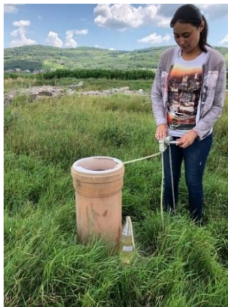
Fig. 3.2. Prelevare probelor de apă din puțurile de verificare (Pf2 în stânga, Pf4 în dreapta) din jurul batalului de nămol Tomești
