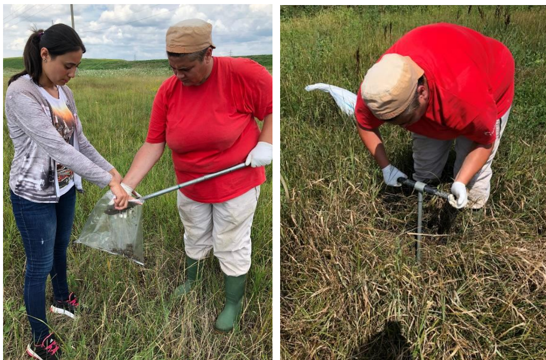
Fig. 3.8 Recoltarea probelor din zona adiacentă batalului de nămoluri din Tomești, sondajele FM și SE
