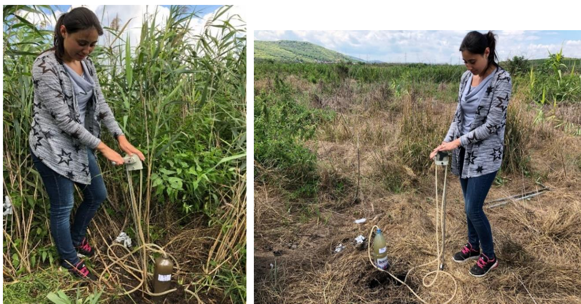
Fig. 3.1. Prelevarea probelor de apă din incinta batalului (S3 stânga, S1 dreapta)
