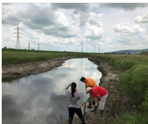
Fig. 3.3. Recoltarea de probe de apă în zona limitrofă batalului de nămol Tomești (în stânga prelevarea probei de apă din amonte, iar în dreapta în aval pe cursul râului Bahlui)
