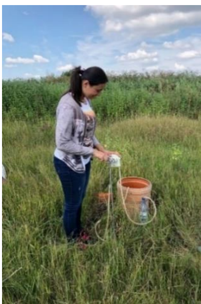
Fig. 3.2. Prelevare probelor de apă din puțurile de verificare (Pf2 în stânga, Pf4 în dreapta) din jurul batalului de nămol Tomești
