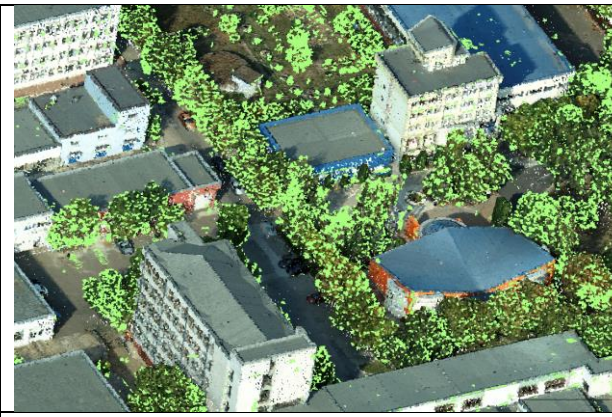
Detaliu nor integrat Phantom4+LiDAR (verde)
